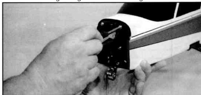
3. Bringen Sie die Motorträger in Position und fixieren Sie diese mit den 3x16mm Schrauben leicht. Achten Sie darauf, dass die Motorträgerhälften mit der Aufnahmeseite nach innen zeigen.
